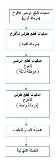
الرسم التخطيطي لمراحل إنتاج أكياس الورق
